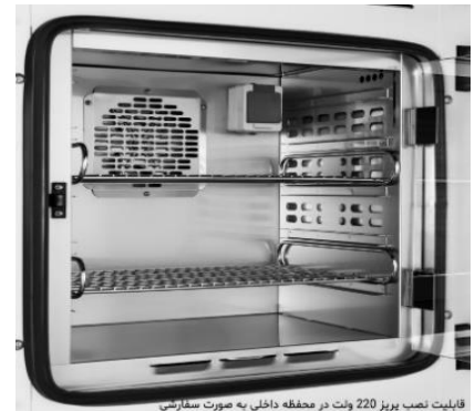
قابلیت نصب پرز 220 ولت در محفظه داخلی به صورت سفارشی
